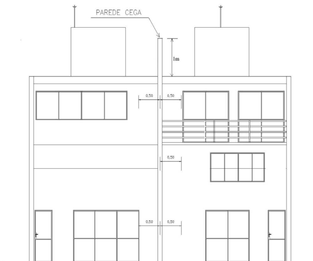
Figura 1 - Distanciamentos e projeção obrigatórios da parede cega.
