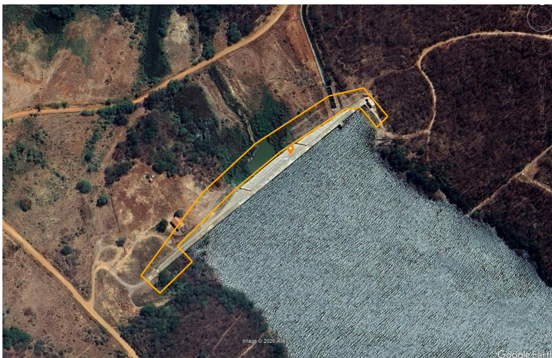
Figura 3 – Vista superior da Barragem Cova da Mandioca com indicação da área a ser realizada limpeza de vegetação: região a jusante e ombreiras.
